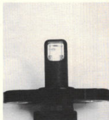
Afb. 5. Opnemerelement van de temperatuursensor.
