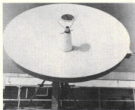
Atb. 1. Een 3 m schotelantenne van Marconi op het dak van het Rutherford Laboratorium bij Oxford vormt een belangrijke schakel in de verbinding met het CERN laboratorium in Genève, Zwitserland.
