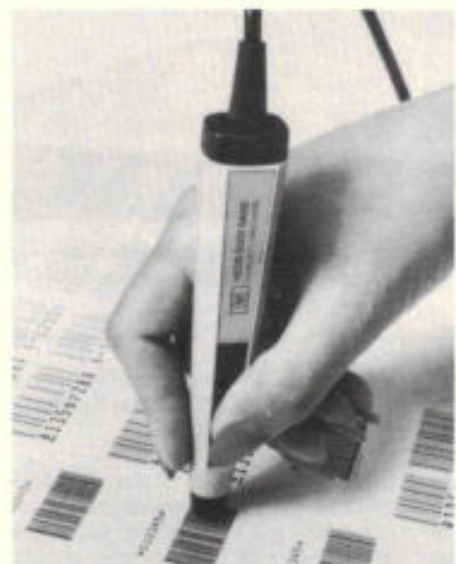
Afb. 1. De HEDS-3000 digitale barcode lezer bevat alle componenten nodig om een gedrukt barcodepatroon om te vormen tot een digitaal signaal geschikt voor gebruik in een dataprocessor.
