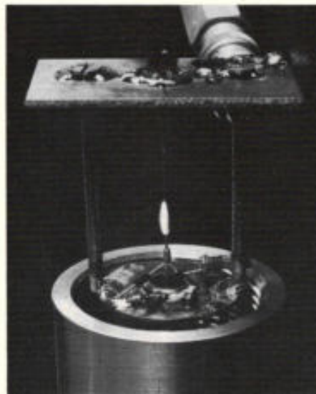
Afb. 13 Test op de bestandheid tegen elektrische ontladingen. M.b.v. een autobobine worden vonken met een lengte van 7 mm toegevoerd aan de ingang van de versterker.
