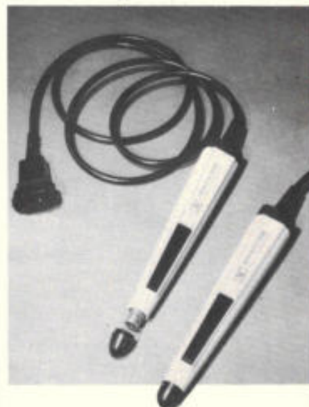
Afb. 8. Het cilindrische lichaam bevat de sensor en de elektronica en wordt bijeen gehouden met twee ringen.
