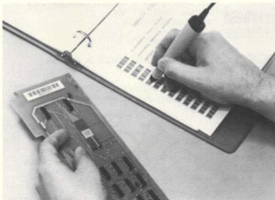
In deze industriële toepassing wordt elke combinatie geïdentificeerd door een barcode en de QA-defectcode wordt direct ingelezen door een streepjescode aftaster vanaf een code-index waardoor kopieerfouten worden vermeden.
